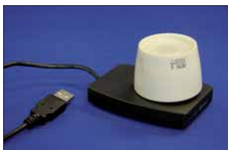
Čip v uzávěru lékovky snímá datum a čas jejího otevření.
